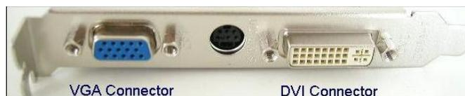
**Fig. 4: Puertos de salida de la tarjeta gráfica dual**
