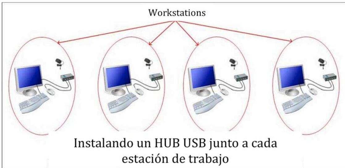
**Fig. 3: Conexión de Workstations adicionales con HUB USB**
